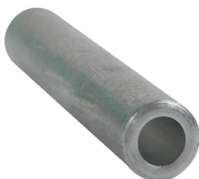
Служит для соединения и ответвления пайкой или опрессовкой проводов и кабелей на напряжение до 10 кВ с алюминиевыми жилами сечением от 16 до 300 мм<sup>2</sup>.
