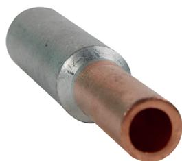
Служат для соединения и ответвления пайкой или опрессовкой проводов и кабелей на напряжение до 10 кВ с медными жилами номинальным сечением от 16 до 185 мм<sup>2</sup> и с алюминиевыми жилами сечением от 25 до 240 мм<sup>2</sup>.
