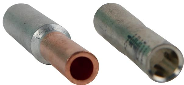
OptiKit C - Гильзы кабельные служат для соединения и ответвления пайкой или опрессовкой проводов и кабелей на напряжение до 10 кВ с медными жилами номинальным сечением от 1,5 до 400 мм<sup>2</sup> и с алюминиевыми жилами сечением от 16 до 300 мм<sup>2</sup>.
