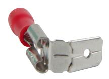
Разъемы плоские ответвительные РпОи обеспечивают оконцевание проводов и кабелей с медными жилами сечением от 0,5 до  $6~{\rm mm}^2$  в электрических цепях переменного и постоянного тока напряжением до  $400~{\rm B}.$
