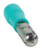
Разъемы слаботочные предназначены для оконцевания проводов и кабелей, создавая соединение по типу «папа», что обеспечивает быстрое замыкание / размыкание цепи переменного и постоянного тока напряжением до 400 В. Опрессовка проводника производится поверх изолирующей манжеты.
