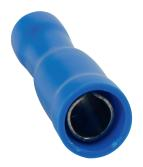
Разъемы слаботочные предназначены для оконцевания проводов и кабелей, создавая соединение по типу «мама», что обеспечивает быстрое замыкание / размыкание цепи переменного и постоянного тока напряжением до 400 В.
