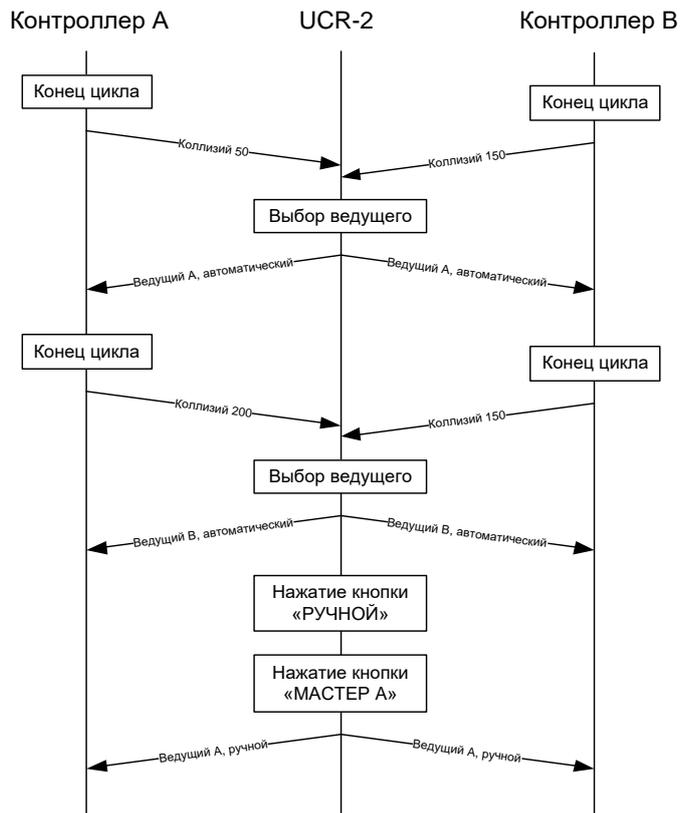
Рисунок 5 Пример обмена контроллеров с устройством
