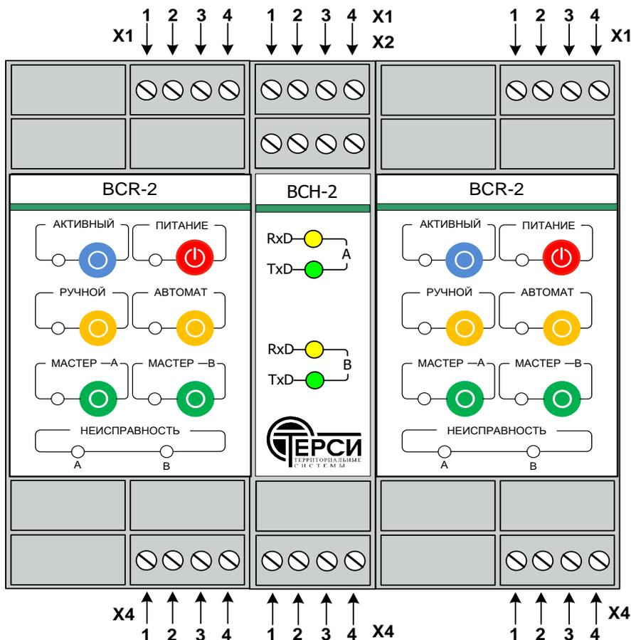
Рисунок 1 Внешний вид устройства UCR-2 и расположение разъемов
