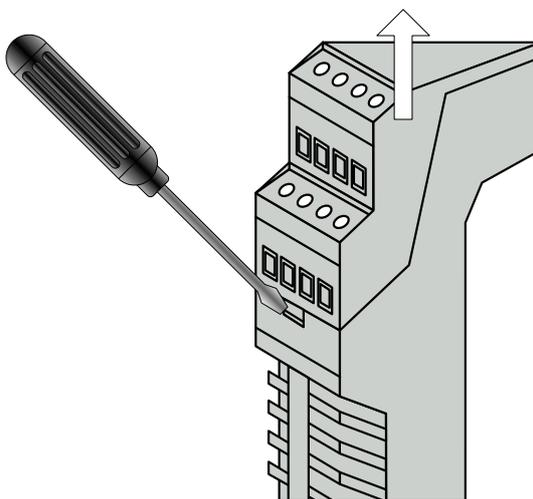
Рисунок 3 Извлечение платы блока BCR-2 из корпуса
