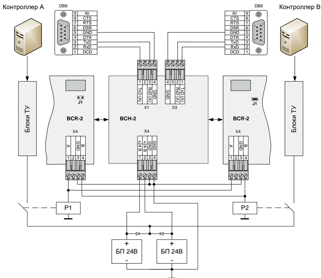
Рисунок 4 Схема подключения устройства
