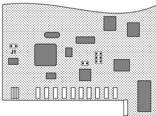
Рисунок 2 Расположение перемычек на плате блока VCR-2
