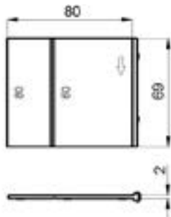
Рисунок Б.1. - Габаритные, присоединительные размеры выключателей
