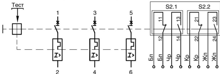
Схема электрическая принципиальная выключателей с электромагнитным приводом, с независимым расцепителем и вспомогательными контактами
