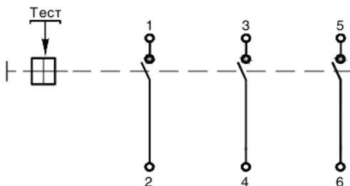
Схема электрическая принципиальная выключателя со вспомогательными контактами
