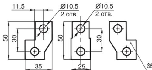
Комплект дополнительных расширительных присоединительных выводов
