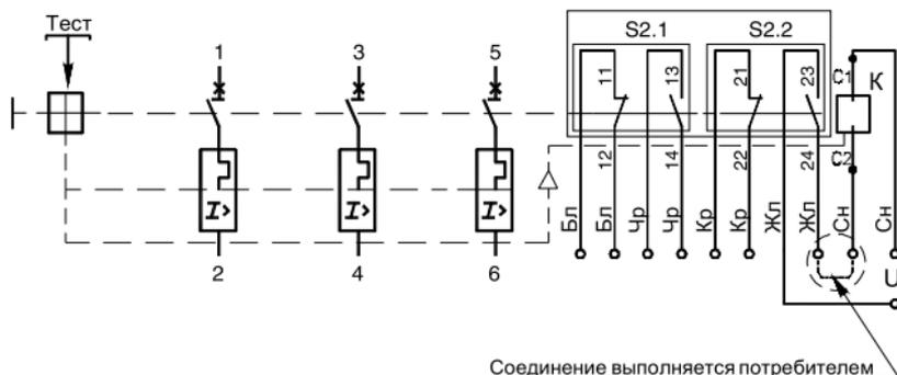
Электрические схемы присоединения внешних проводников к зажимам выключателей в цепях постоянного тока
