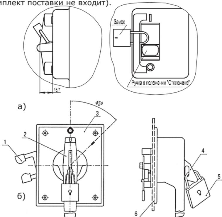
а) выключателей стационарного исполнения с ручным приводом,
