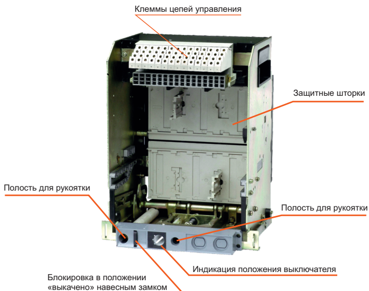
Рисунок 2 – Корзина выключателя OptiMat A-S1
