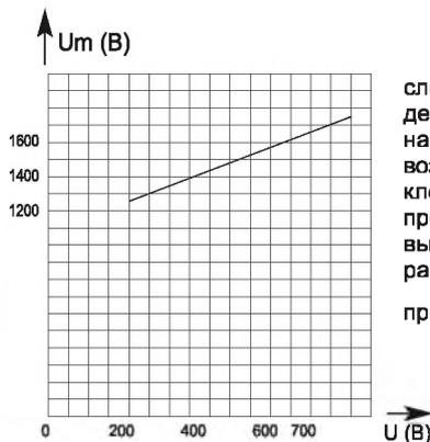
слева: кривая демонстрирует пиковое напряжение дуги  $U_m$ , возникающее между клеммами предохранителя, выраженное как функция от рабочего напряжения  $U$  при  $\cos\phi = 0.15$
