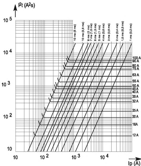
вверху: для каждого номинала тока горизонтальные кривые показывают максимальные значения итогового отключающего  $I^2t$  ( $I^2t$ ) как функцию от ожидаемого тока короткого замыкания  $I_p$  @ 690 В при  $\cos\phi = 0.15$
