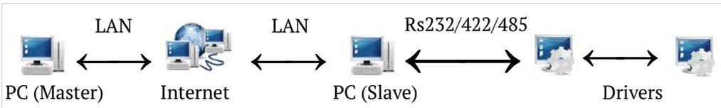
Удаленное подключение по сети LAN через Internet позволяет управлять преобразователем на большом удалении при относительно небольшой стоимости. Если вы подключаетесь к сети через фаерволл или прокси-сервер, не забудьте обеспечить доступ к порту.
