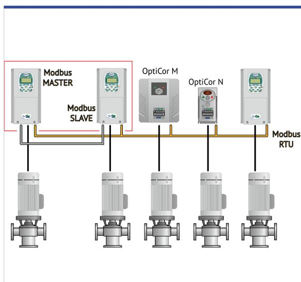
На диаграмме показана конфигурация насосной станции с регулируемыми насосами, управлением по последовательной связи и функцией нескольких ведущих.
