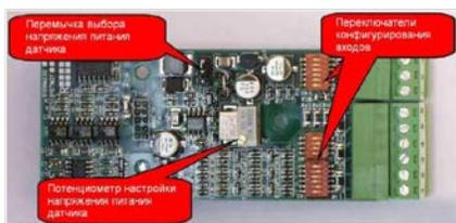
Плата для инкрементного реверсивного датчика, используемого в качестве источника обратной связи для преобразователей серий OptiCor P. Позволяет подключать датчики с питанием от +5 до +15 В (настраиваемое) с комплементарными выходами (выходы line driver, двухтактный, TTL). Возможно также подключение датчиков с питанием +24 В как с комплементарными, так и с несимметричными двухтактными или PNP/NPN выходами.
