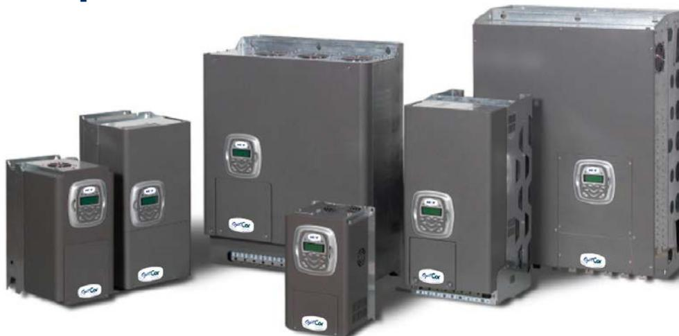
Преобразователи серии OptiCor P, охватывающие диапазон мощностей от 2,2 кВт до 3 МВт, позволяют регулировать скорость и момент трехфазных асинхронных двигателей и бесщеточных двигателей переменного тока с постоянными магнитами, используя несколько различных алгоритмов управления. Конкретный режим управления выбирается пользователем и позволяет получить оптимальные характеристики работы в условиях точной настройки и сохранения энергии для любого промышленного применения.
