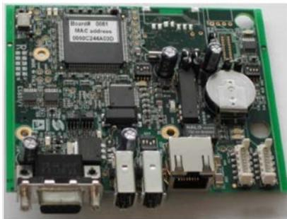
Плата ES851 DataLogger представляет собой опциональную плату, обеспечивающую сбор данных о параметрах системы и передачу их на контролирующий компьютер, даже удаленный.
