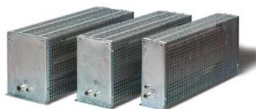
Тормозные резисторы в исполнении IP55, IP20. Преобразователи серии OptiCor P размеров от S05 и S30 поставляются со встроенным тормозным модулем. Тормозной резистор подключается к клеммам В и +. Для больших размеров (S40 и выше) используется внешний тормозной модуль (MFI).
