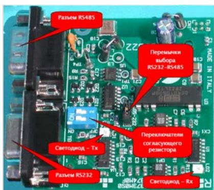
Изолированная плата последовательной связи с интерфейсом RS 232/485 для управления преобразователями OptiCor P позволяет подключить компьютер через интерфейс RS232 или организовать многоточечное соединение по протоколу MODBUS через интерфейс RS485. Она обеспечивает гальваническую изоляцию сигналов интерфейса, как от общего провода платы управления, так и от общего провода клемм платы управления.
