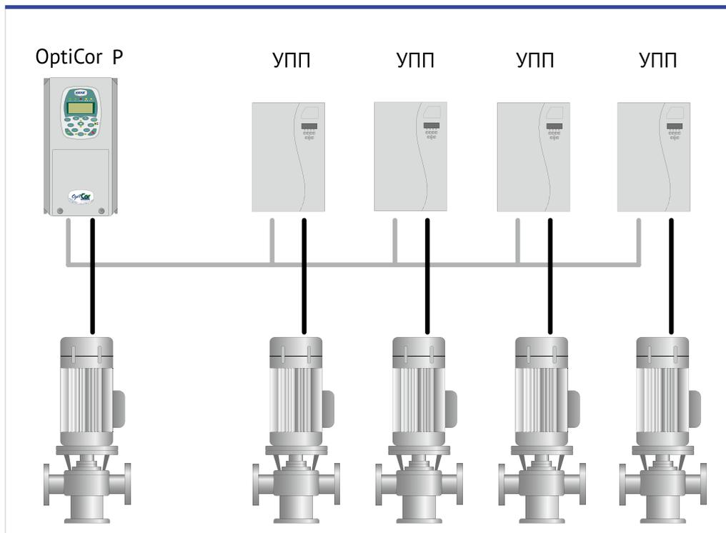
Стандартная схема подключения насосной станции с одним регулируемым насосом и четырьмя насосами с фиксированной скоростью, аналоговое управление.
