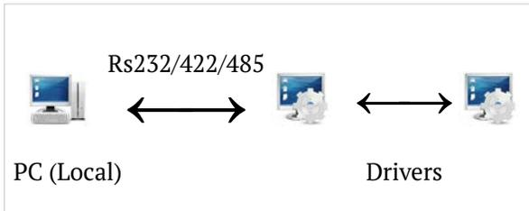
Программа позволяет получать и отображать графически все параметры, измеряемые прибором. Полученные данные могут быть затем сохранены в файле. Прямое подключение: компьютер подключен к приводу напрямую при помощи кабеля последовательной связи RS232/RS485.
