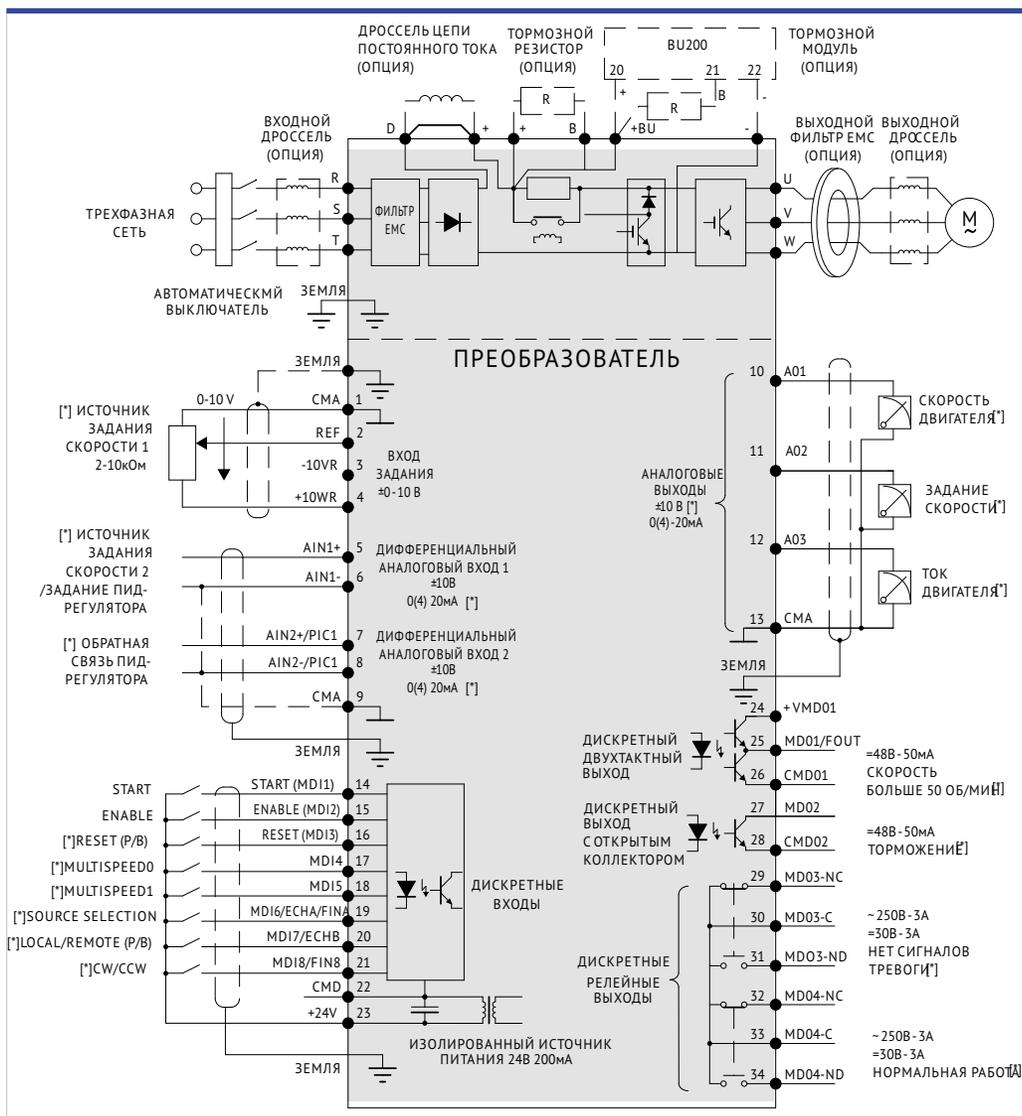
Схема управления изображена для подключения с заводскими установками.
