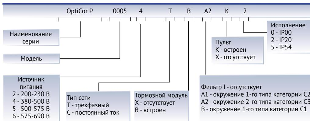
Преобразователь частоты OptiCor P
