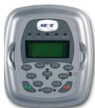
Пульт управления для OptiCor P, для просмотра и программирования параметров: 12 функциональных кнопок, 5 светодиодов, жидкокристаллический дисплей. При работе на дисплее отображаются значения параметров, аварийные сообщения (при их наличии) и значения измеренных величин. Имеющиеся языки: итальянский, испанский, португальский, немецкий, французский, русский.
