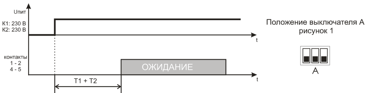
Рисунок 3 – Алгоритм работы “Реле с задержкой на включение”
