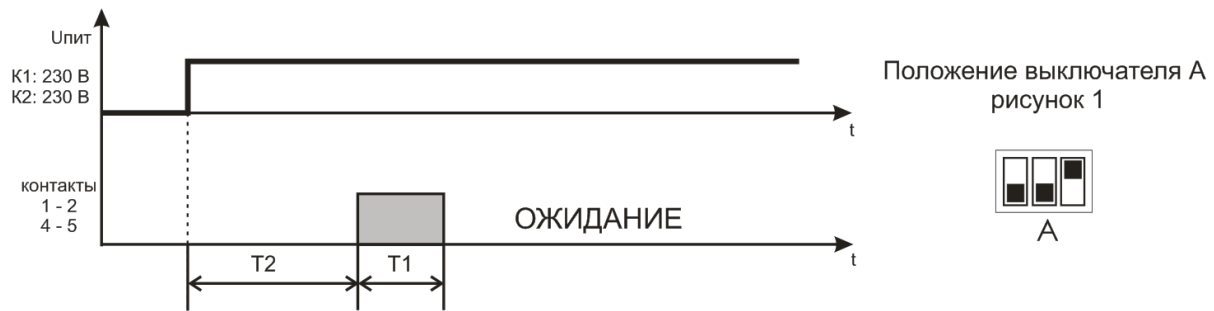
Рисунок 4 – Алгоритм работы “Реле импульсное 1”
