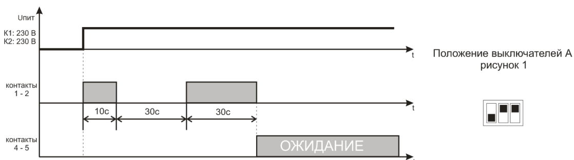
Рисунок 6 – Алгоритм работы “Реле управления (предпусковая сигнализация)”
