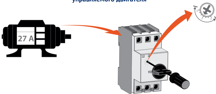
Установка тока управляемого двигателя
